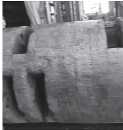
この日、シュレッダーの刃の交換を行っている 最中で滅多に見れない大型シュレッダーの刃が
