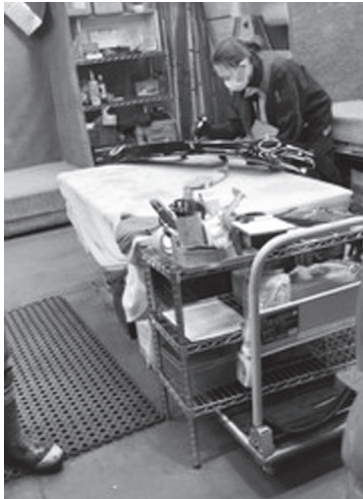
部品解体分別されたエンジンパーツのクリーニング
