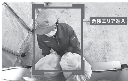
手が隠れた状態での検知イメージ
